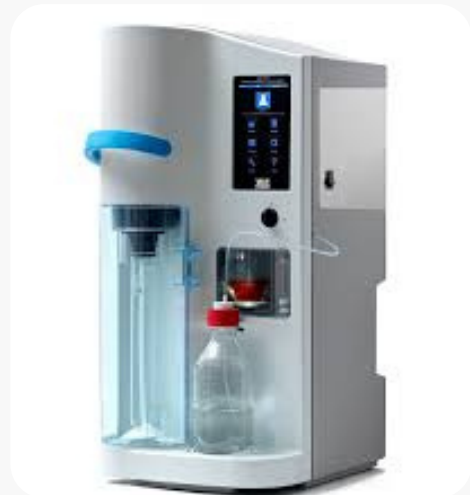
Hệ thống chưng cất Đạm Kjeldahl
